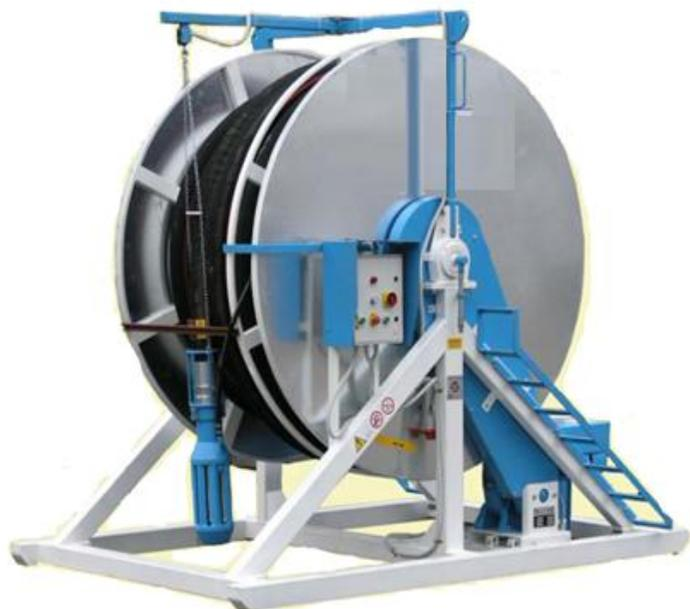
Sistema aspirazione bentonite Air lift
