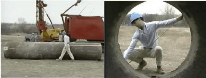
In questa fotografia l'ispettore sta verificando la lunghezza del rivestimento, il diametro, interno, ed esterno lo spessore del tubo per aggiungerlo al form di ispezione.
