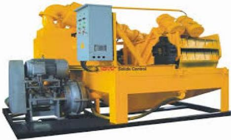
Il **dissabbiatore**, è usato per rimuovere la sabbia dal fluido di perforazione e mantenerne il contenuto nei limiti specificati dalle normative, di costruzione.
