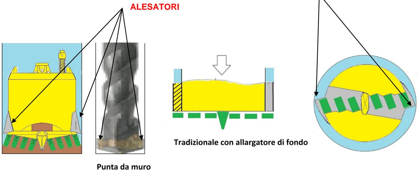
Questo spiega l’utilità degli allargatori e perché le punte da muro ne siano provviste, essi creano il vuoto necessario alla rimozione, poichè altrimenti l’utensile nell’impasto di polvere creato dalla perforazione, si bloccherebbe.
